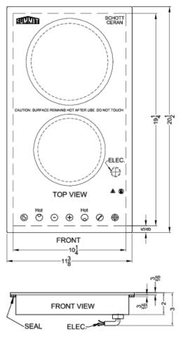
MODEL: CR2B23T3B CR2B23T4W 220-240V-60HZ 3000W MAX.
